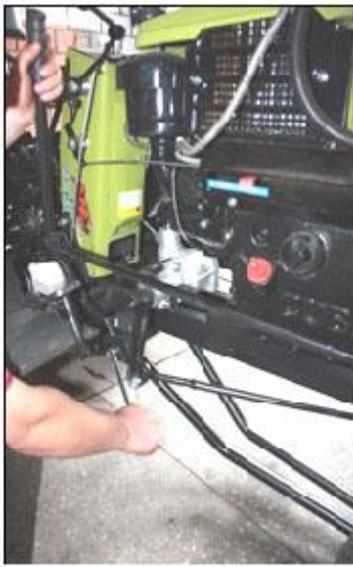
3. Крепим фиксатор рычага.
