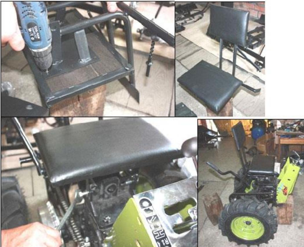
7. Устанавливаем раму, наживив болты и не затягивая их до конца.
