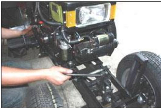
7. Соединяем кулису и подъемную конструкцию «серьгой».
