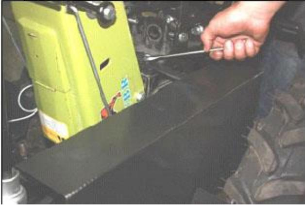
16. Устанавливаем главный тормозной цилиндр с бачком. Заливаем жидкость, прокачиваем тормоза.
