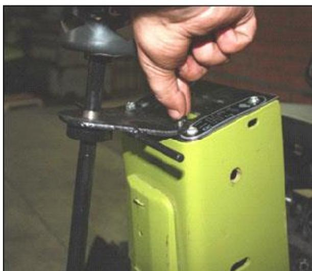
13. Устанавливаем рычаги выключения блокировки полуоси.
