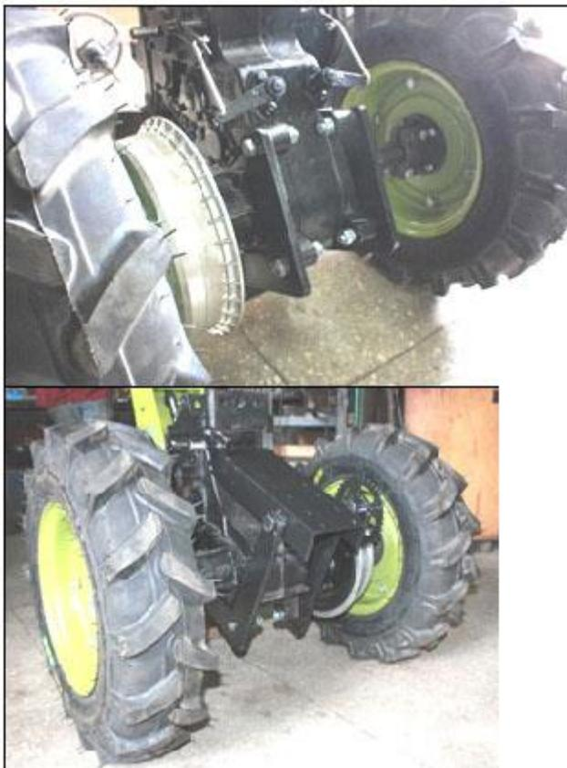
2. Устанавливаем ведущую звездочку привода фрезы на вал отбора мощности.
