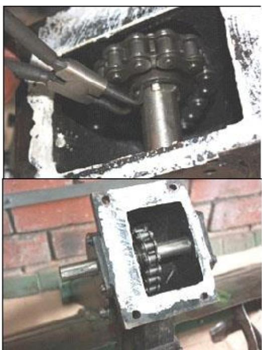
4. Теперь на вал закрепим ведомую звездочку привода фрезы, засверлив крепежное отверстие  $\text{Ø } 8$  мм, глубиной 4 мм, закручиваем болт, выставляем соосность. Присоединяем фрезу к переходной плите, предварительно смазав картер герметиком.
