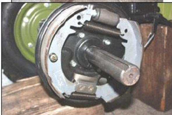
3. Теперь нужно установить барабан. Необходимо отрегулировать зазор между опорным диском и барабаном, после чего - засверлить отверстие  $\varnothing 8$  мм, глубиной 4 мм в полуоси для стопорного винта. Устанавливаем шпонку и ступицу колеса.
