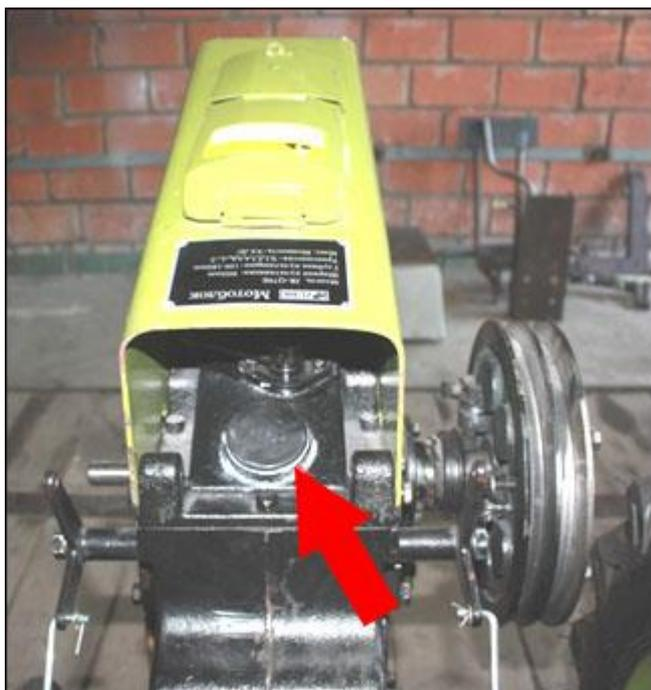
2. Снимаем правое колесо мотоблока вместе со ступицей и устанавливаем опорный диск с тормозными колодками при помощи болтов с внутренним шестигранником.
