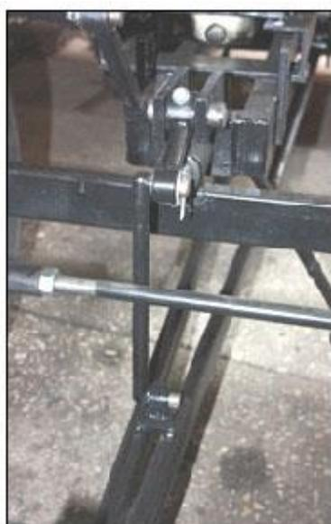
7.Соединяем «лыжу» с лопатой-отвал. Опускаем рычаг подъема переднего механизма в нижнее положение и фиксируем болтами «лыжу» с лопатой.
