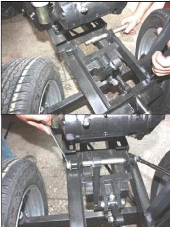
6. Соединяем рычаг и кулису подъемной конструкции тягой.
