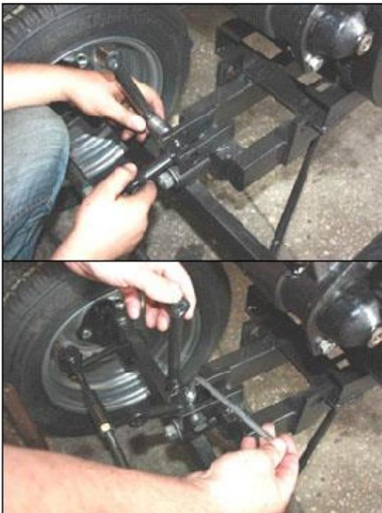
5. Монтируем подъемный механизм косилки роторной типа КР-01Б.
