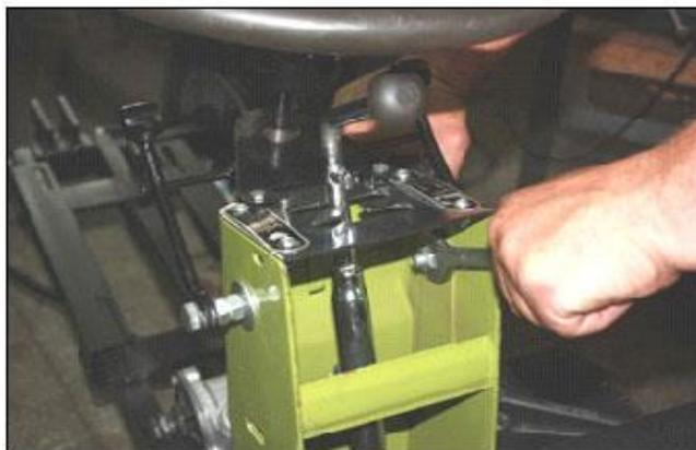
14. Откручиваем и поворачиваем шайбу-упор выжимного подшипника на 1/3 против часовой стрелки. Укорачиваем и загибаем тяги сцепления и рычагов выключения блокировки полуоси.
