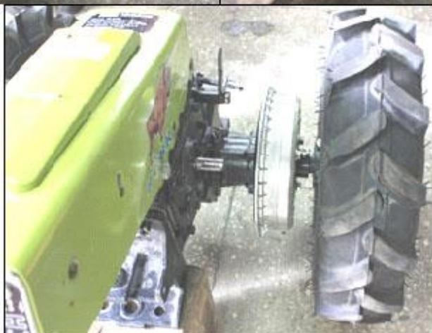
4. Монтируем задний подъемный механизм и затягиваем болты до упора.
